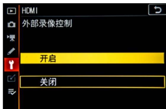
支持 **Atomos** 开放协议的信息，请咨询其生产商）开始和停止录制。照相机在视频即时取景模式下显示 **STBY**，在视频录制期间显示 **REC**。视频录制期间，请检查第三方数码外录设备和第三方数码外录设备显示，以确认短片被保存到设备中。
